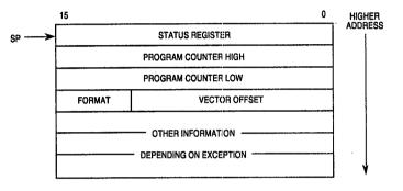
Figure 6-6. MC68010 Stack Frame
